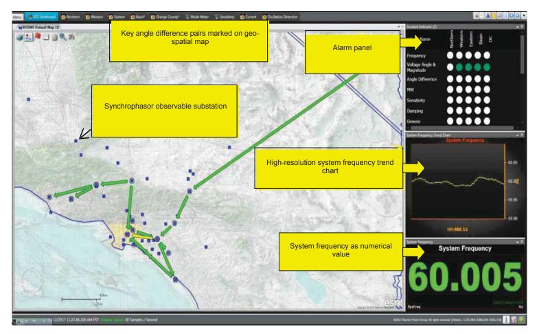
Figure 2. RTDMS Dashboard at GCC
